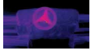
İzocam Vana Ceketini uygulamasından sonra yalıtımlı vananın termal kamera görüntüsü
